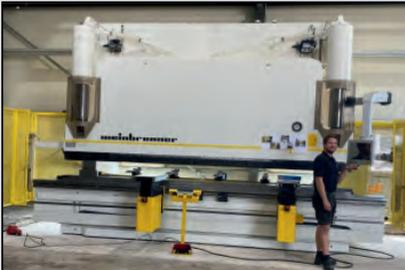
Mit unseren drei Gesenkbiegepressen, kanten wir Blechbauteile bis zu einer Länge von 4500mm.
