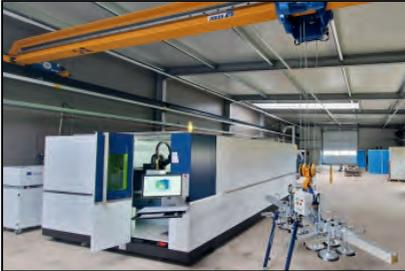
Mit unseren drei Trumpf-Laseranlagen, fertigen wir Laserzuschnitte bis zu einer Größe von 4000x2000mm.
